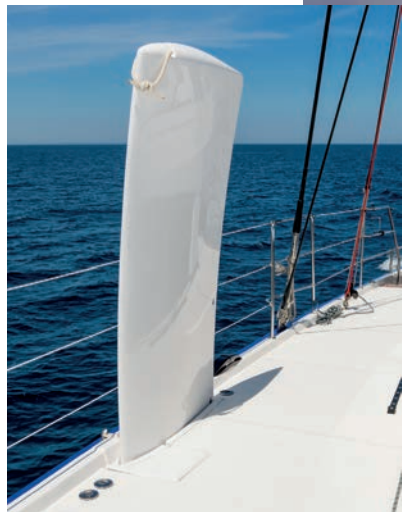
↑ Les dérives courbes s'intègrent mieux dans les aménagements et sont susceptibles de fournir une petite poussée verticale à haute vitesse
