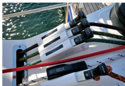
← Une partie du poste de manœuvre bâbord en bout de bras. La circulation des bosses de ris, de l'écoute de GV ou de la balancine a fait l'objet d'une étude spécifique pour rendre l'ensemble lisible
